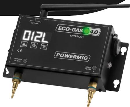
O ECO-GÁS 4.0 é um sistema integrado de controle de gás, que possibilita sua regulagem de forma sinérgica e automática, de acordo com a corrente de soldagem, durante todos o processo de solda. Ele indica o consumo instantâneo ou cumulativo de gás, podendo ser zerado diariamente, conferindo desta forma, controle preciso do uso de cada processo.
